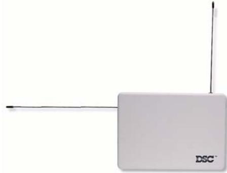
Receptor de Señal de botón Inalámbrica, Alimentacion de 12 vcd alambrica Contacto seco N/A N/C para alambrar la zona a la que corresponde el receptor al panel de control, Alcance Mínimo 30 Metros Acepta la recepción de cuando menos 10 botones.
