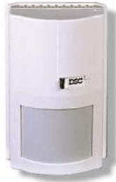
Pasivo Infrarrojo Inalámbrico Inmune a mascotas hasta 60 lbs para protección de interiores, procesador (MLSP) Cobertura de 12.2 x 15.2 Metros, lentes intercambiables, apagado por alto tráfico, 2 baterías de litio ( 5 años de vida) incluye base de montaje, tamper de protección, facilidad de prueba de movimiento para el instalador. Instalación, elementos de Conexión, sujeción herrajes y tornilleria.
